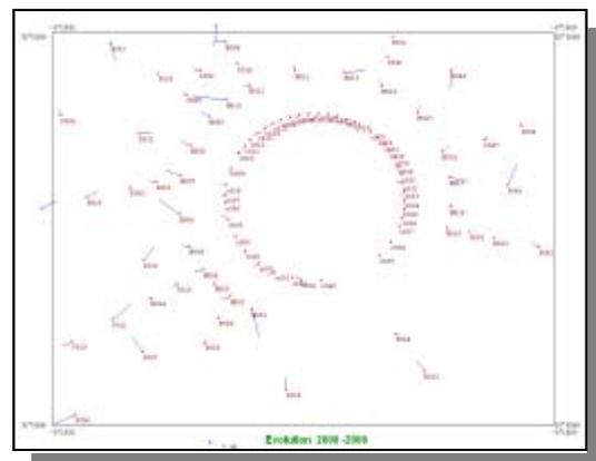
**Figure 7 : Planimetric displacements 2000-2006**
