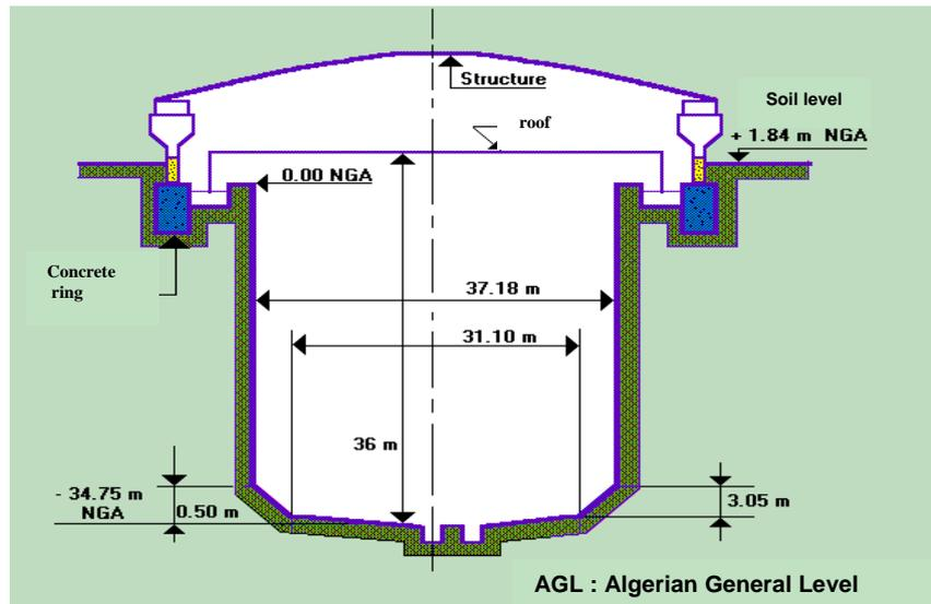
Figure 1: LNG INGROUND STORAGE TANK T5101
